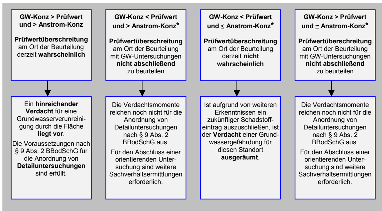
Abbildung 6: Ergebnis der Sickerwasserprognose auf der Basis von Grundwasseruntersuchungen bei orientierenden Untersuchungen
