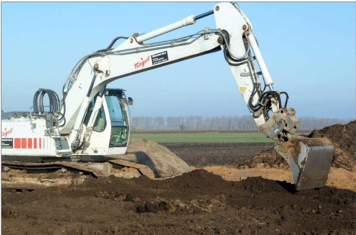
Abb. 11: Aufbau einer durchwurzelbaren Bodenschicht (© Schnittstelle Boden)
