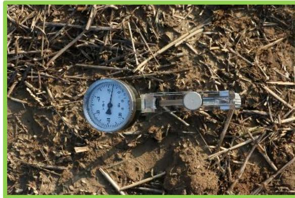
Abb. 13: Messung der Bodenfeuchte mittels Tensiometer (© Schnittstelle Boden)
