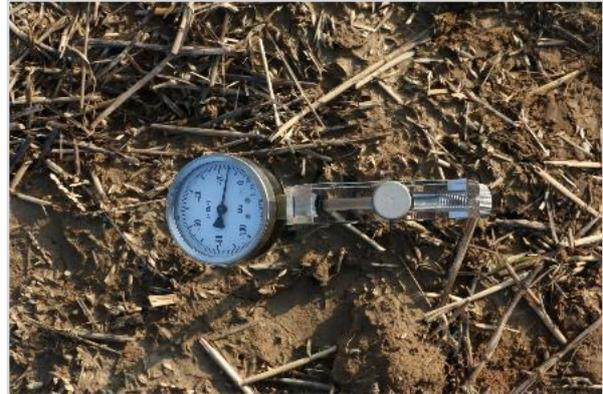
**Abbildung 23: Messung der Bodenwasser-spannung mittels Tensiometer (© Schnittstelle Boden)**
