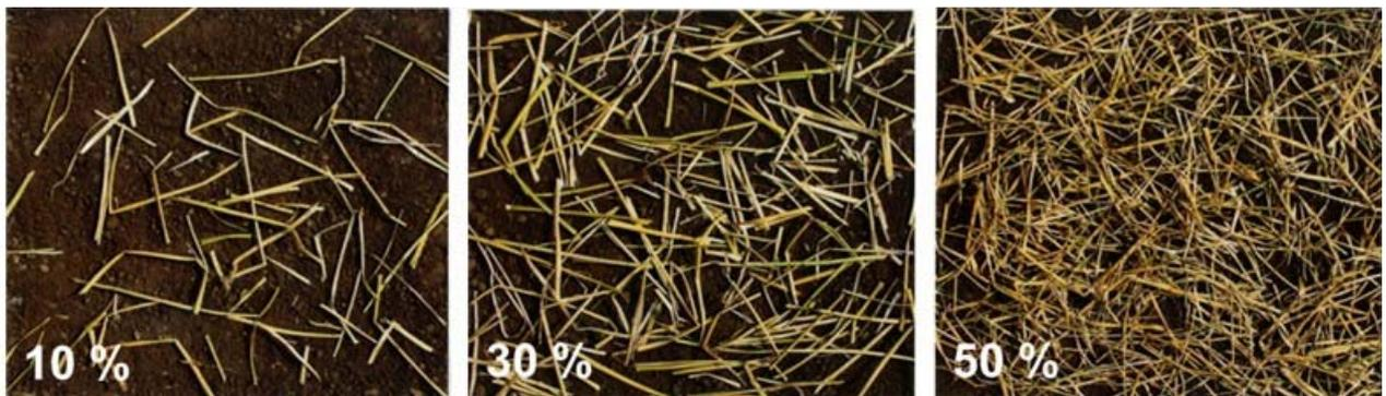
Abbildung 3: Bestimmung des Bodenbedeckungsgrades durch organische Rückstände nach Brunotte FAL 2007, verändert.
